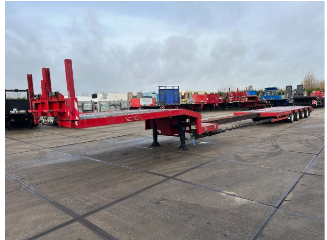
Nooteboom 4 Assige dieplader, 6,4 M Uitschuifbaar, laatste 2 ...
