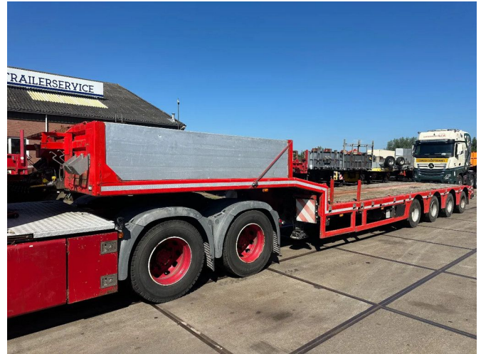
Kässbohrer 4 AXLE LAST 2 STEERING, EXTENDABLE
