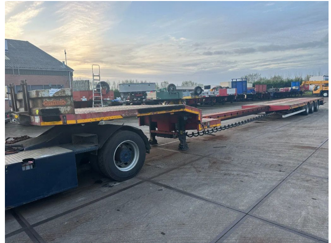
Nootboom OSDS-48-03V LAST AXLE STEERING, 6,8 M E...
