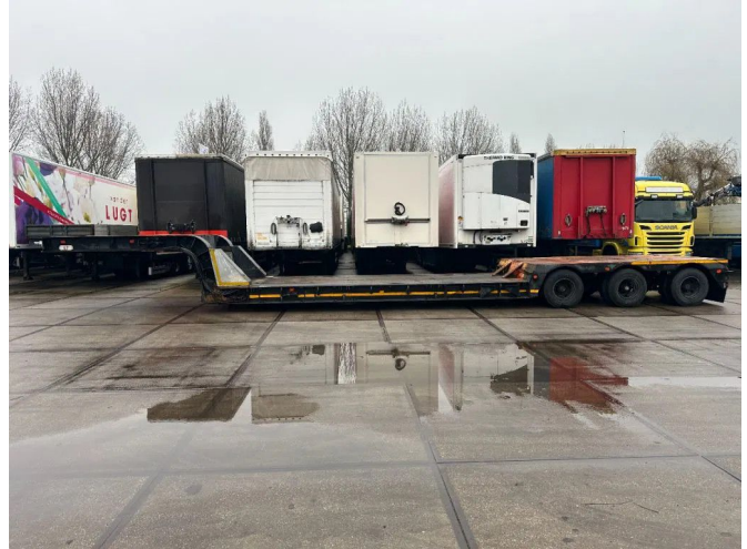
Nootboom 3 AXEL STEERING, 3,6 M EXTENDABLE
