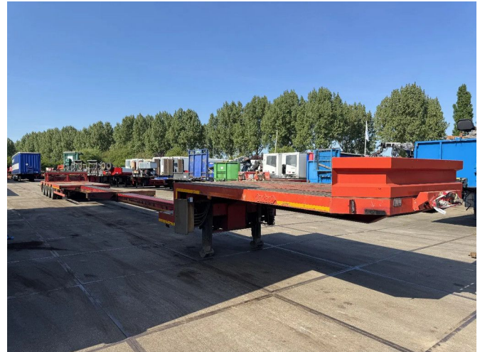
Nootboom MCO-58-04V - 4 AXLE BPW + 2X EXTENDABLE
